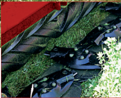
Вальцовый плющильный аппарат, вальцы обрезиненные
