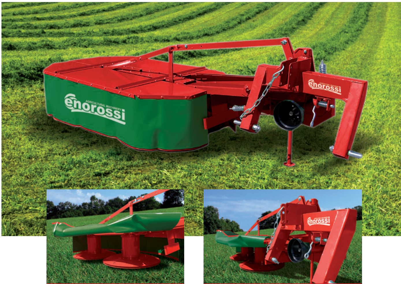
Диски широкого диаметра с 3 ножами
