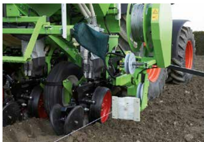
Тросовая система управления с механизмом размотки
