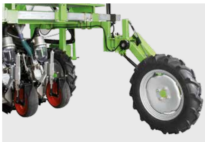
Измерительное колесо с телеметрическим датчиком
