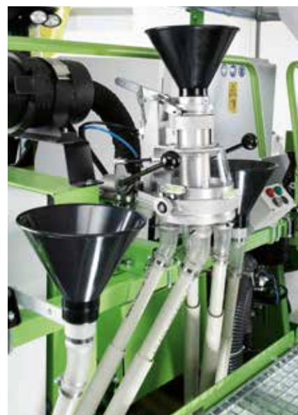
Конический дозатор и отдельные воронки
