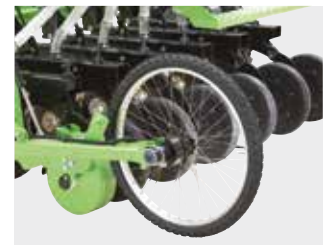
Датчик перемещения, установленный на колесе
