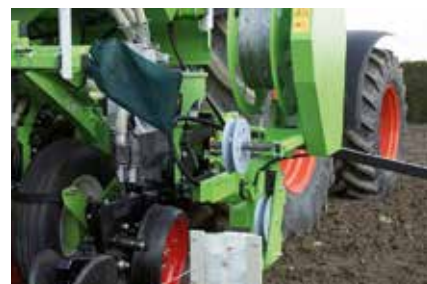
Тросовая система управления с механизмом размотки
