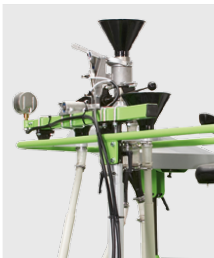
Отдельная воронка и центральный дозатор посевного материала
