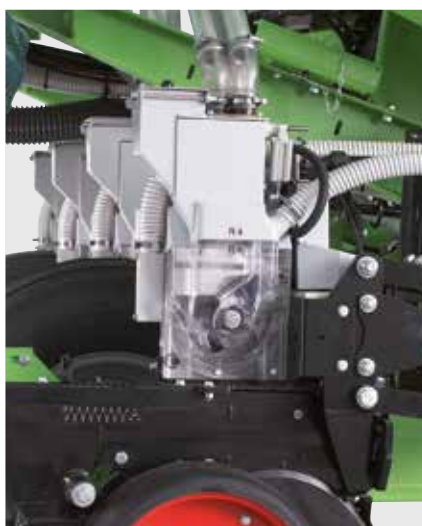
Прозрачный кожух высевающего элемента для обеспечения оптимального обзора
