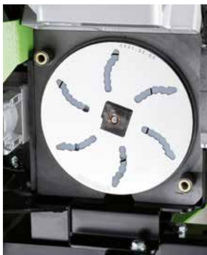
С радиальным пазорезным диском и, находящимся за ним спиральным шлицевым диском
