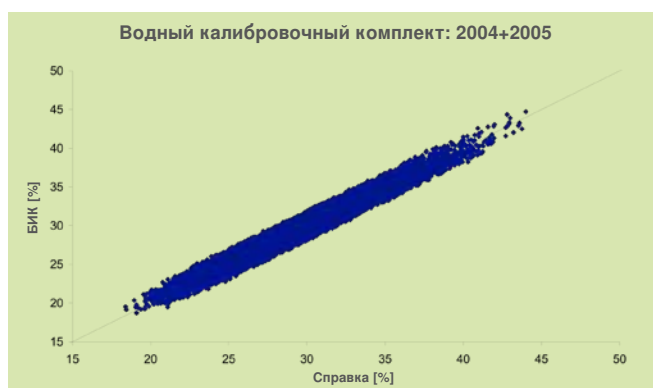
Перекрестная содержания воды в кукурузе с опорными значениями двух сезонов уборки
