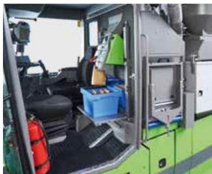
Встроенная система хранения проб и ящиков
