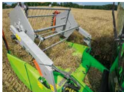
Оптимальный поток материала за счет разделенного питающего шнека
