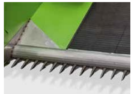
Порожек предотвращает потерю зерна
