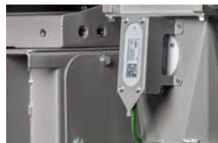
Радиолокационный датчик для контроля потока зерна
