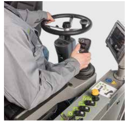
Многофункциональный рычаг, встроенный в подлокотник
