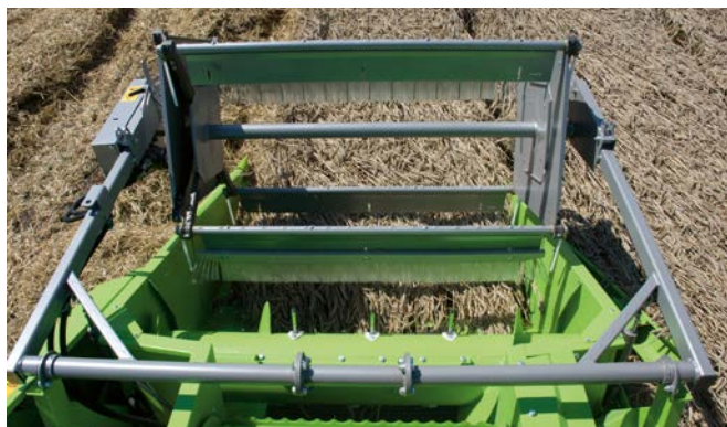
Зерновая жатка с лентой транспортера; без наклонной камеры
