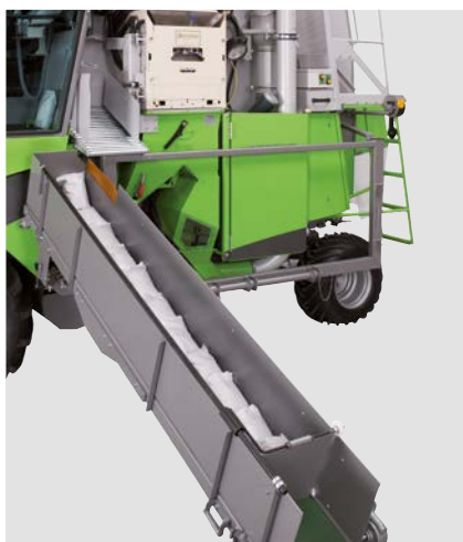
Регулируемая высота разгрузки ленточного транспортера для проб
