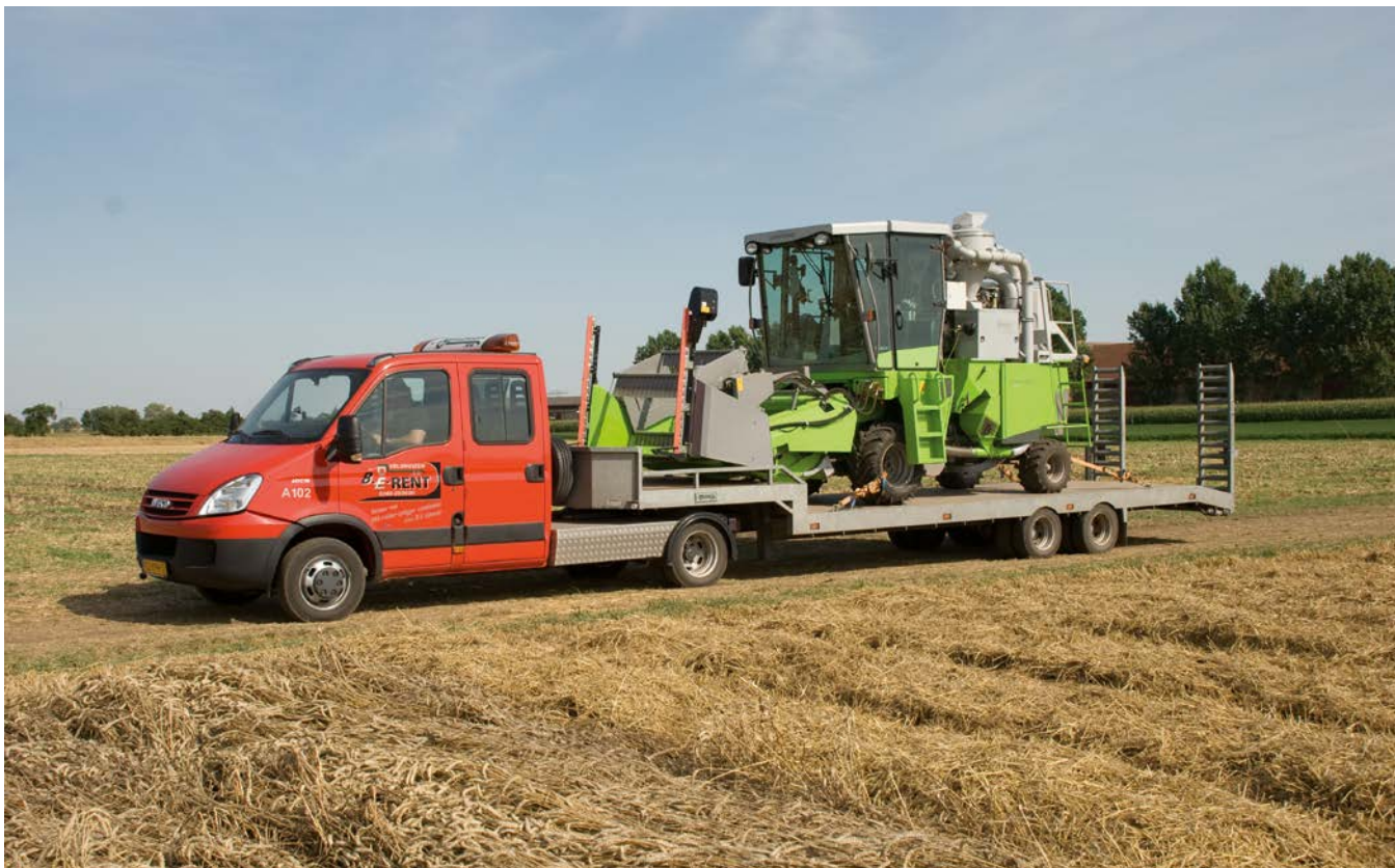
Благодаря компактности конструкции транспортировка машины не требует демонтажа каких-либо узлов (макс. транспортная высота: 2950 мм)
