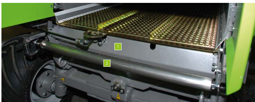
1 Электропривод пластинчатого сита 2 Датчик потерь зерна 3 Ширина открывания сита в % 4 Текущие потери зерна (%) относительно заданного макс. значения
