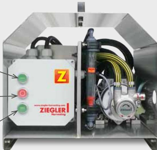
Die Einstellung der Durchflussmenge mittels Mengeneinstellventil mit den unterschiedlichen Düsengrößen.
